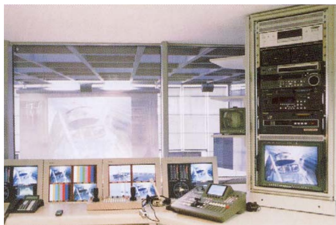
Rechts neben dem Tonarbeitsplatz die Bildregie mit Bildmischer, Kamerasteuerung und mehreren Splitscreen-Monitoren, die die konventionelle Monitorwand ersetzt. Das Zuspielrack ist drehbar gelagert und kann auf diese Weise sowohl von der Bildregie als auch vom Schnittplatz genutzt werden.
